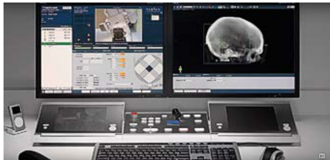
slika br.7: upravljačka konzola linearnog akceleratora
